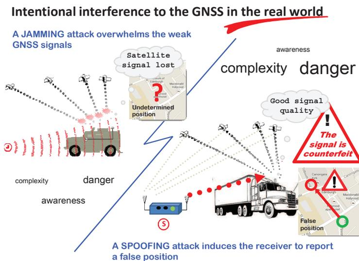
Fig. 4. Schematizzazione di attacchi *jamming* e *spoofing*.
