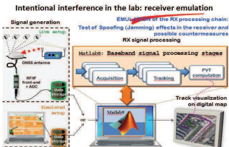
Fig 5. Simulazione del sistema di rilevamento attacchi ed emulatore per sottosistema RX.
