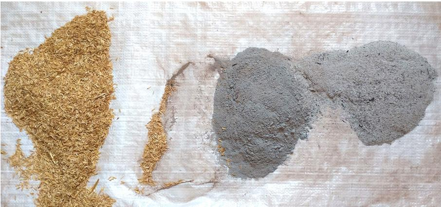
Fig. 2. Campioni di loppa di riso, ottenuti dopo il processo di sbramatura (sinistra), in seguito a combustione (destra) e dopo la rimacinazione finale (centro).
